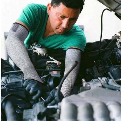
**Mangas de Protección Contra Cortes:** fabricadas con materiales resistentes a cortes y abrasiones, protegen los brazos durante tareas que involucran herramientas afiladas o materiales peligrosos.
